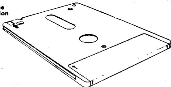
Lorsque l'encoche est bouchée, l'ordinateur peut écrire des données sur le disque. Par contre, si elle est ouverte, l'écriture de données ne sera pas permise, ceci afin d'éviter l'effacement accidentel de programmes importants.
