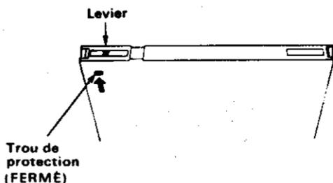
Pour ouvrir l'encoche de protection, faites glisser le levier vers le milieu du disque à l'aide d'une pointe de stylo ou d'un outil similaire.
